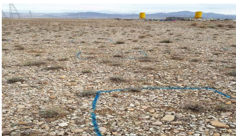
شکل ۱- مشخص کردن محل حفر گودال با رنگ به منظور قرار دادن تشت تبخیر کلرادو
