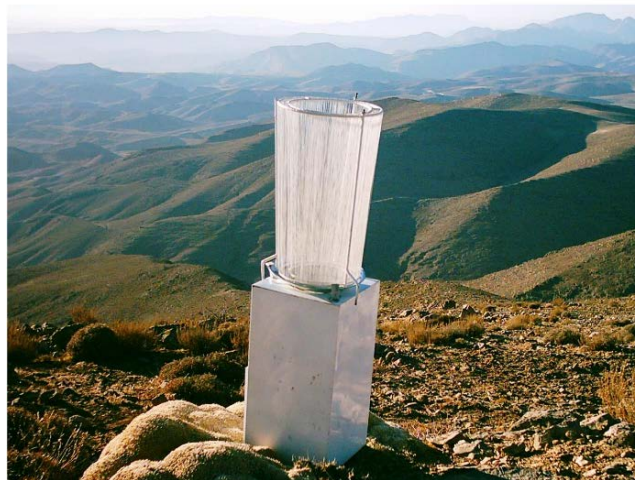
شکل ۸: جمع کننده مخروطی دو جداره
