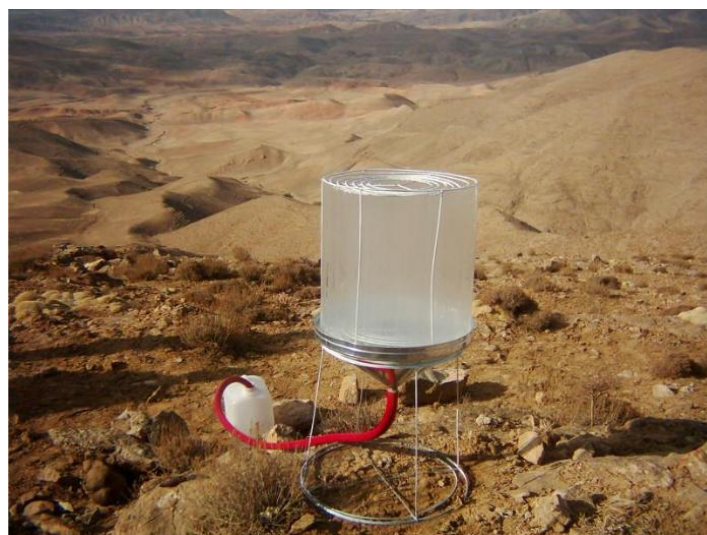
شکل ۹: جمع کننده مخروطی چند جداره
