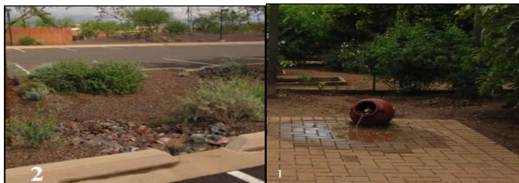
شکل (۶): یک سنگفرش نفوذ پذیر (۱) و (۲) برش لبه پیاده روها برای هدایت آب به فضای سبز را نشان می‌دهد (http://www.perviouspavement.org).
