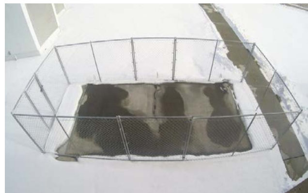
شکل ۱۰- بتن رسانای ذوب برف
