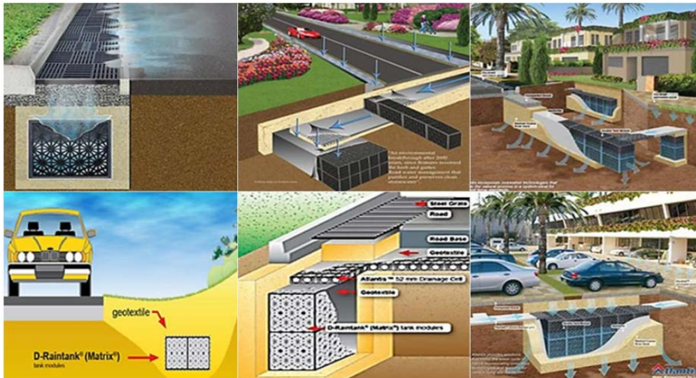
شکل ۷- اجرای کانال‌ها و مخازن اکولوژیک در شهرک سجاده تهران (امانیور و همکاران، ۱۳۹۵)
