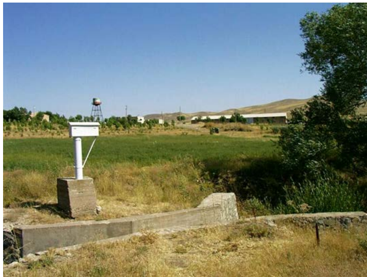
شکل ۱- اندازه گیری میزان هدر رفت خاک و آب با استفاده از پارشال فلوم
