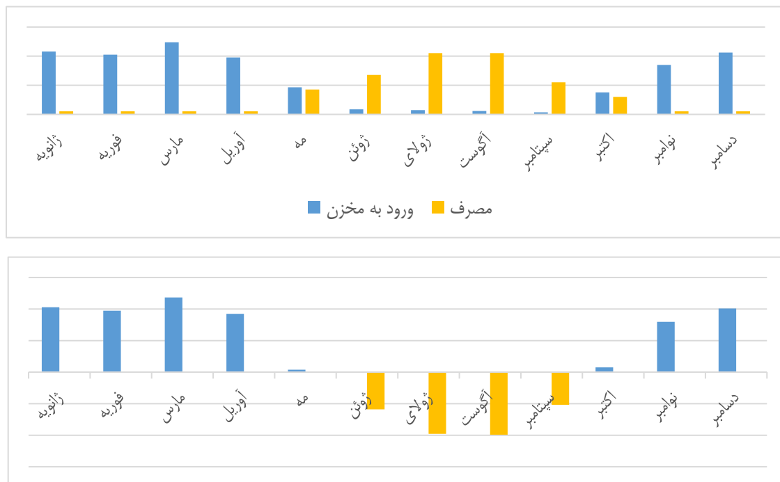
شکل ۱- مقایسه میزان ورود آب به مخزن و مصرف در ماه‌های مختلف سال (بالا) و بیلان آب در مخزن (پایین) در ساختمان فرضی الف
