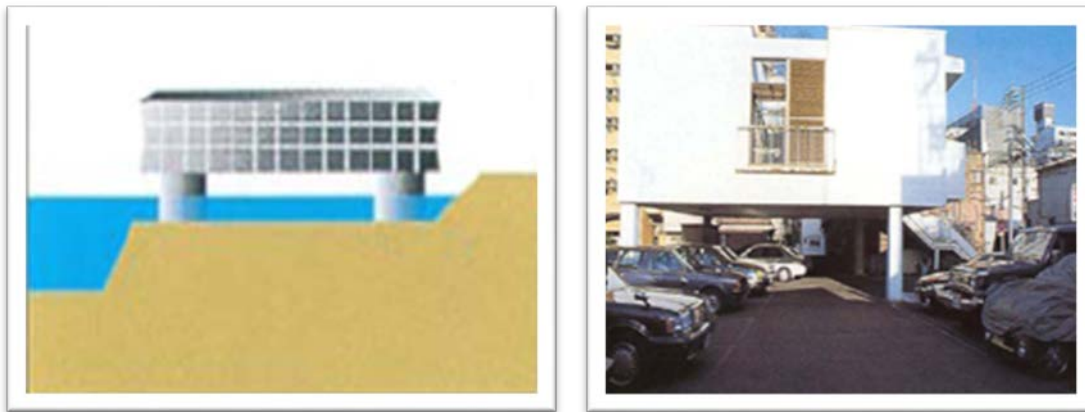
شکل ۷- طراحی مناسب ساختمانهایی که در حریم رودخانه‌ها قرار دارند
