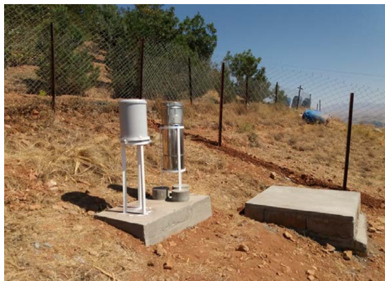
شکل ۴- ایستگاه باران‌سنجی احداث شده در کنار پروژه استحصال آب باران
