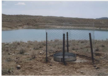
شکل ۳- تشتک تبخیر نصب در محل سد خاکی دره مرید
