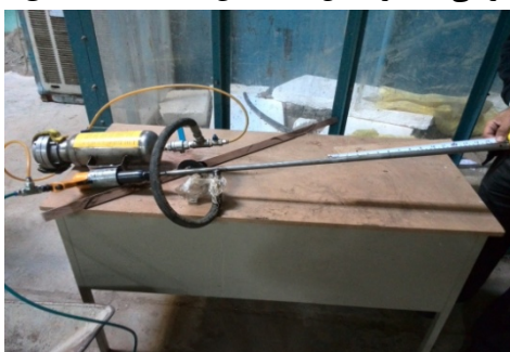
شکل (۳) - دستگاه مدرج تزریق ابر جاذب (مخزن ۲ لیتری)
