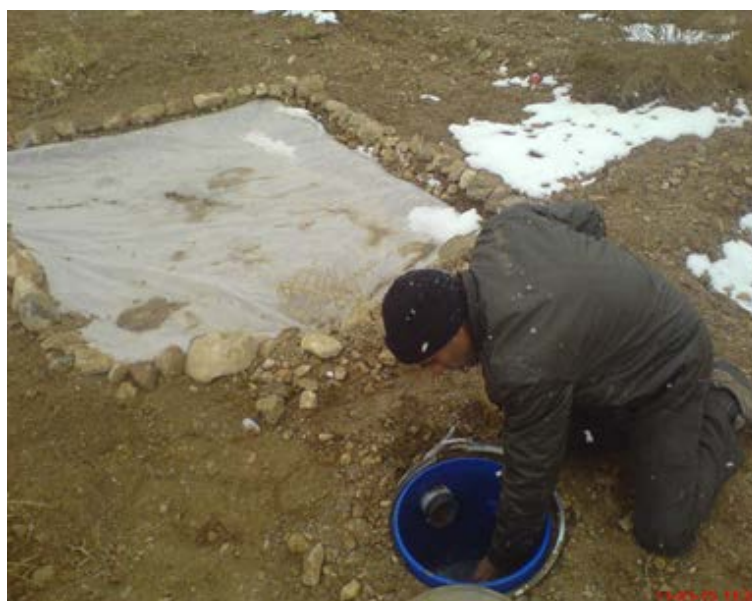
شکل ۲- تصویری از سطح عایق و مخزن‌های در حال تخلیه از باران
