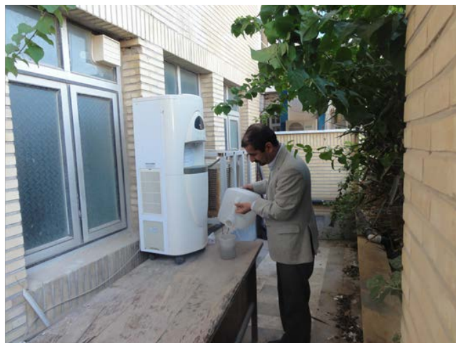
شکل ۲- نحوه اندازه‌گیری آب تولید شده بر اساس لیتر در ساعت در طول شبانه‌روز
