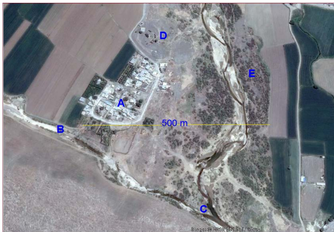
شکل ۳- بازه میانراهان؛ روستای خدرآباد در حریم رودخانه (A)، بازه خدرآباد (B)، خروجی حوضه میانراهان و تلاقی بازه خدرآباد و میانراهان (C)، کارگاه ماسه‌شویی (D)، روبش زیاد درختچه گز رودخانه‌ای در سالیان اخیر (E). آثار تخریب کناری با شخم و توسعه زراعت در حاشیه بازه مشخص است.
